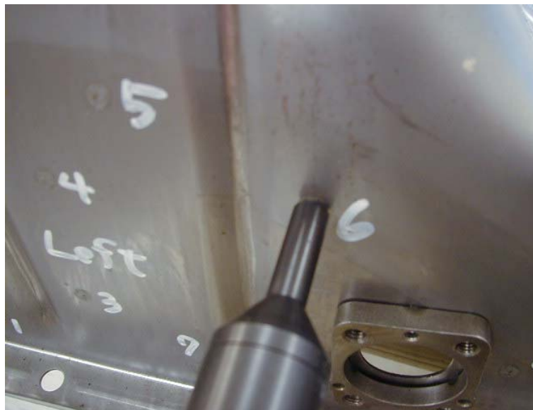
(ペン型センサーによるスポット溶接検査)
